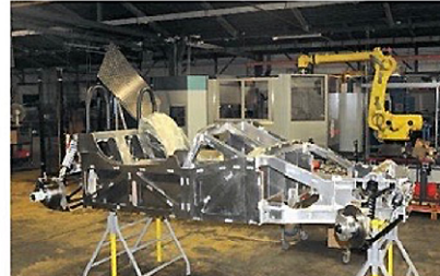
Le châssis devant l'un des robots servant à son assemblage.
