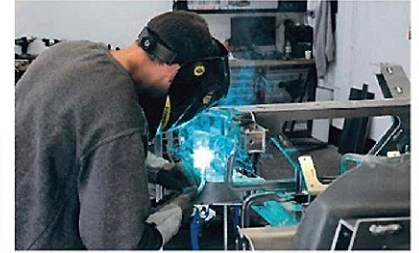
Le cellule centrale ainsi que les berceaux avant et arrière sont fabriqués puis assemblés sur place.
